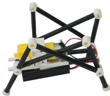
圖 11. 四足吸管機器人示意圖
